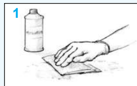
Figura 6 Pulire la superficie. Se necessario, utilizzare un solvente per rimuovere ogni minima traccia di agente contaminante.
