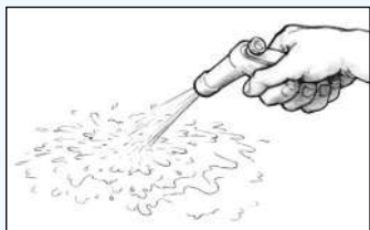
Figura 33 Dopo la carteggiatura sciacquare la superficie con acqua dolce.
